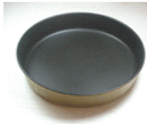
图2 收缩试验圆盘 Fig.2 The test disc
