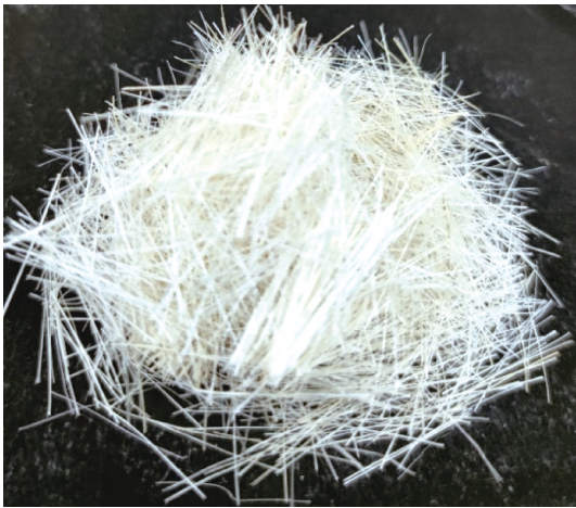
图2 客土改良材料——剑麻纤维
