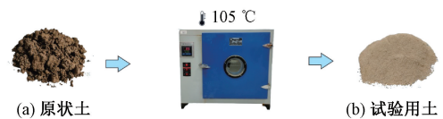
图1 试验所用土样制备流程
