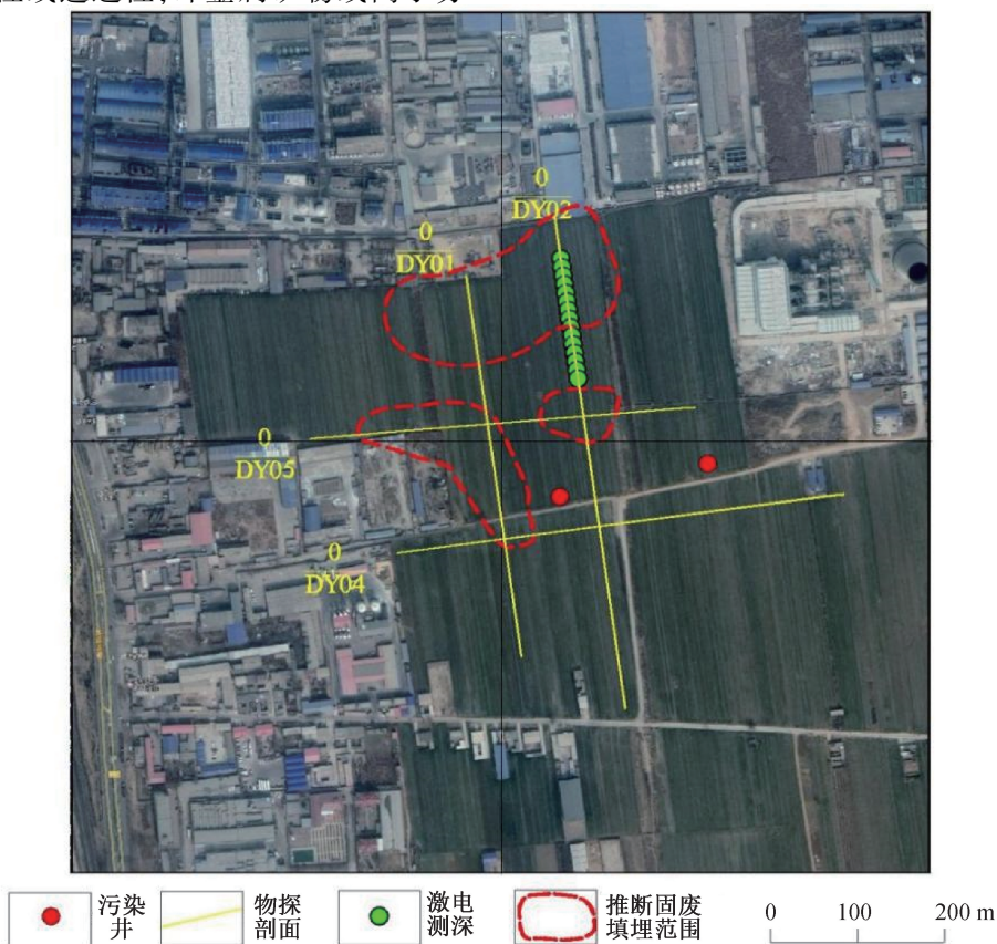
图1 物探工作平面布置及推断固废范围平面图
