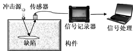
图1 冲击回波法检测原理示意图
