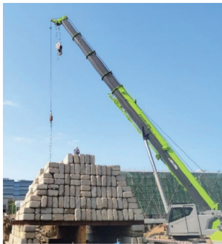
图 1 试验 1 现场堆载
