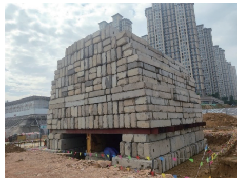
图 2 试验 2 现场堆载
