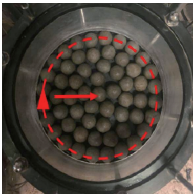
图7 杂填土试样装样完成图
