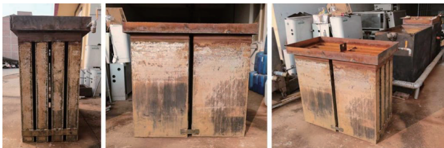
(b) U型蓄冰槽系统实物图
