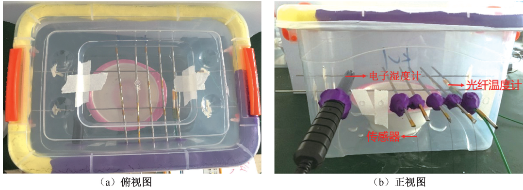
图 5 控湿箱中的传感探头
