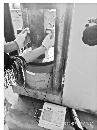
图2 超声波检测混凝土
