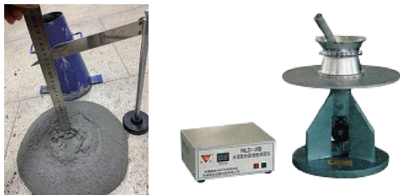
(a) 跳桌试验 (b) 塌落度试验
