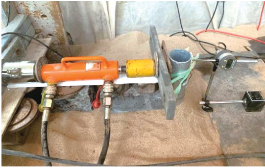
图 3 试验加载及测量装置
