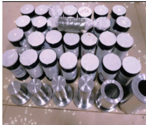
图5 试样养护方法和试样保护装置
