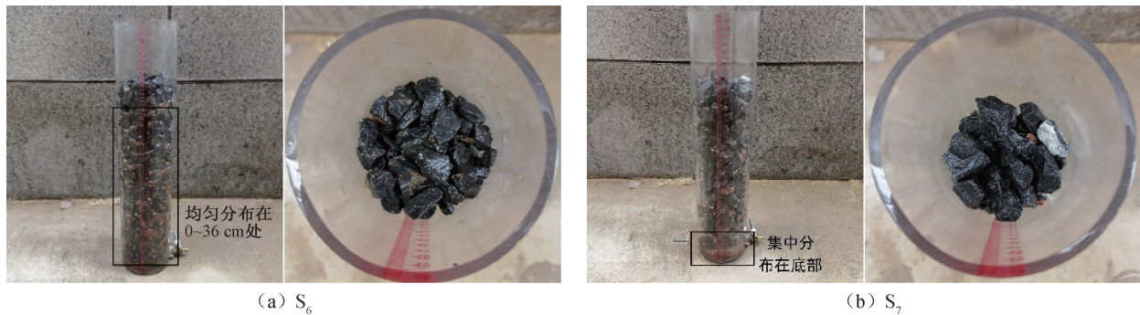
图 10 堵塞后的碎石渗井
