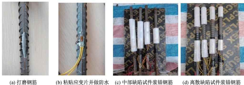
图 2 应变片粘贴及缺陷模拟
